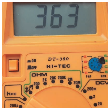
Rysunek 1.8. Tranzystor po eksperymentach ma nadal zdolność wzmocnienia h_{FE}
