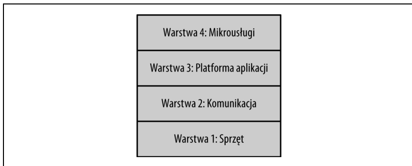
Rysunek 1.7. Czterowarstwowo model ekosystemu mikrousług
