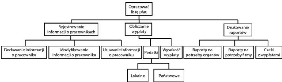
RYSUNEK 3.2. Pierwsza strona uzyskanego metodą od ogółu do szczegółu projektu programu kadrowo-płacowego obejmuje szczegóły z najwyższego poziomu
