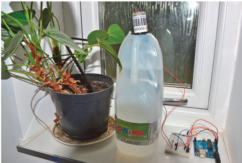
Rysunek 7.16. Urządzenie podlewające domowe kwiaty
